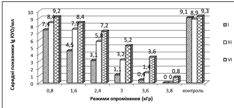
Рис. 1. Життєздатність тест-штамів P. aeruginosa в модельних зразках після опромінення електронним пучком, де I – перший день спостереження після опромінення, III – третій день, VI – шостий день
